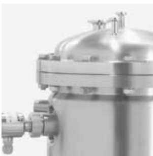
Branche: Biotechnologie Bauteil: Druckbehälter Verfahren: Innen elektropoliert, Ra \leq 0,5 \mu m
